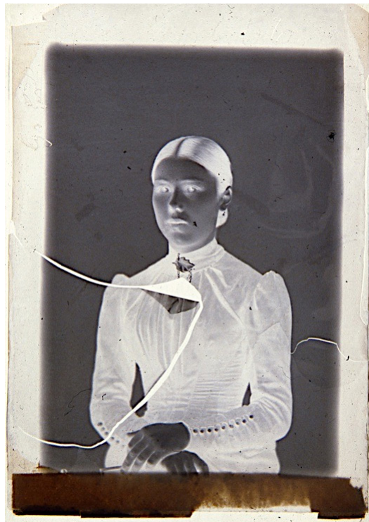
Bild 25. Silvergelatinsplåt med emulsion som krakelerat och lossnat p g a varm och torr förvaring.
